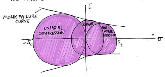
A VARIATION OF MOHR'S THEORY, CALLED THE COULOMB-MOHR THEORY IS BASED ON 2 SIMPLE TESTS: TENSION & COMPRESSION
